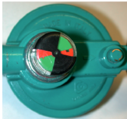
zdjęcie 6. Ciśnienie gazu w butli od 1 do 2 bar około 0,2-0,8 kg tj. czas użytkowania 1-4 godzin
